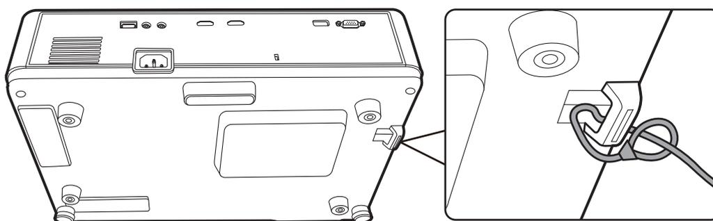
**HINWEIS:** Der Sicherheitssteckplatz kann auch als Sicherungsanker verwendet werden, wenn der Projektor an der Decke montiert wird.
