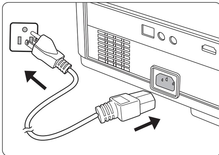
**HINWEIS:** Bei der Installation des Projektors ist eine leicht zugängliche Trennvorrichtung in die feste Verkabelung zu integrieren oder der Netzstecker an eine leicht zugängliche Steckdose in der Nähe des Geräts anzuschließen. Sollte während des Betriebs des Projektors ein Fehler auftreten, verwenden Sie die Trennvorrichtung, um die Stromversorgung auszuschalten oder den Netzstecker zu ziehen.
